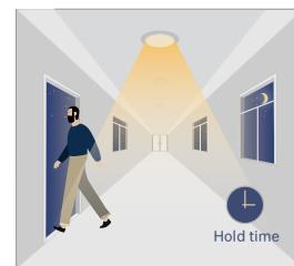
感应器检测不到运动后，自动进入延时时间；延时时间段内灯亮100%。
