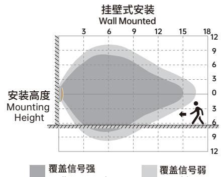
此图表示探测范围为100%时检测距离的参考图。
